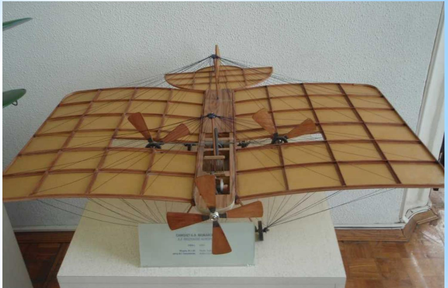
**Первый в мире самолет («воздухолетаательный снаряд») с паровым двигателем на дровах спроектирован и построен русским морским офицером Александром Фёдоровичем Можайским в 1882 году. По проекту самолёт должен был иметь размах крыла 23 м, длину фюзеляжа 15 м. Расчётная скорость полёта составляла 40 км/час. Во время испытаний аппарат на короткое время оторвался от земли.**
